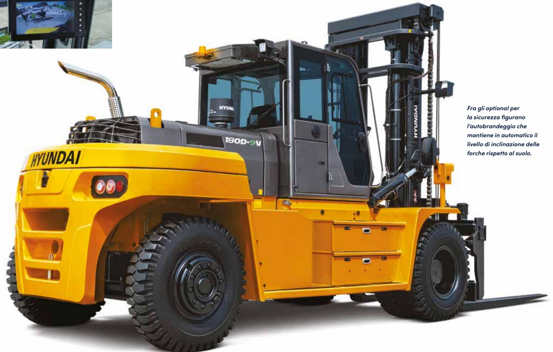
*Fra gli optional per la sicurezza figurano l'autobrandeggio che mantiene in automatico il livello di inclinazione delle forche rispetto al suolo.*
