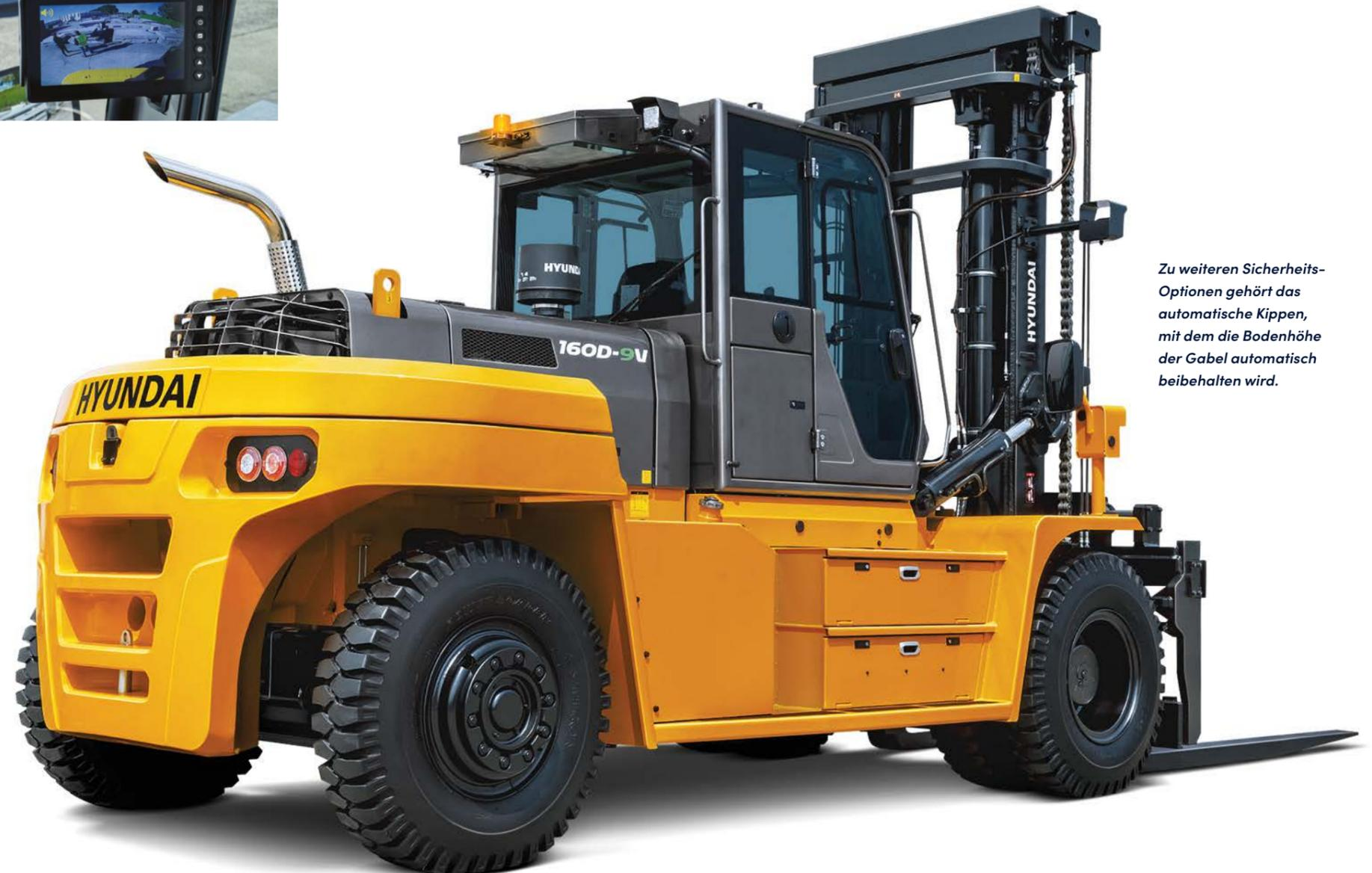
Zu weiteren Sicherheits-Optionen gehört das automatische Kippen, mit dem die Bodenhöhe der Gabel automatisch beibehalten wird.
