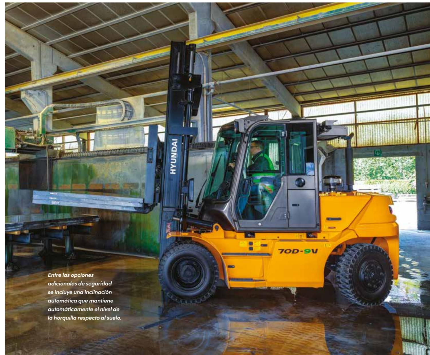
Entre las opciones adicionales de seguridad se incluye una inclinación automática que mantiene automáticamente el nivel de la horquilla respecto al suelo.
